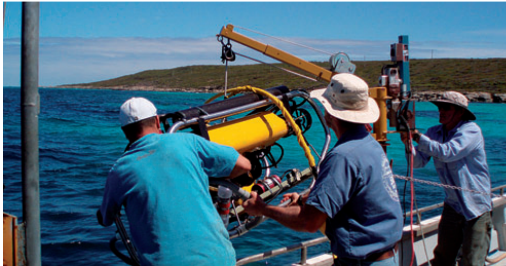
Immersion d'un robot sous-marin devant prendre des images du câble de transmission des données reliant les hydrophones de la station hydroacoustique HA1 à la côte, à Cape Leeuwin, en Australie occidentale, pendant des activités d'inspection, en 2009.
