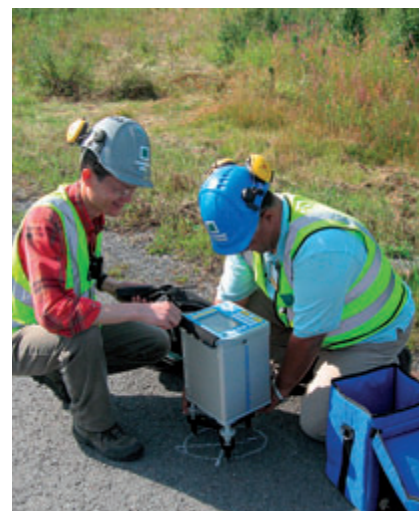
Réalisation de mesures gravimétriques relatives pendant l'opération dirigée qui a eu lieu en Finlande en juillet-août 2009.
