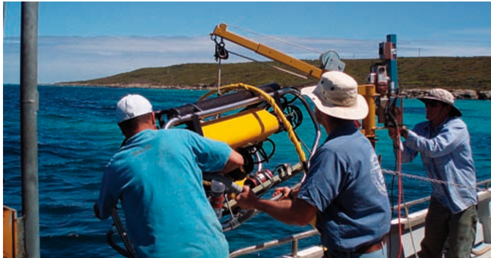
在 2009 年视察期间，用起重机把一个遥控工具放入水中，以便对连接水声台站 HA1 水听器与西澳大利亚州卢因角海岸的数据传输电缆进行录像。
