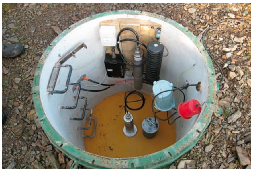
位于联合国埃斯克代尔缪尔的辅助地震台站 AS104 地震台阵的仪器槽之一。
