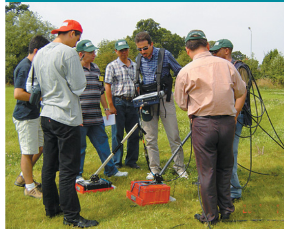
Démonstration de matériel d'inspection sur place au Royaume-Uni: démonstration et essai de deux types de géoradar.
