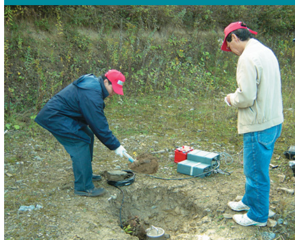
Installation d'une station de surveillance sismologique lors de l'opération dirigée réalisée en 2004 en Slovaquie.
