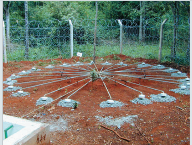
صفيحة أنابيب تخفيض ضوضاء الرياح في محطة الرصد دون السمي ٣٢٣ في نيروبي، كينيا.
