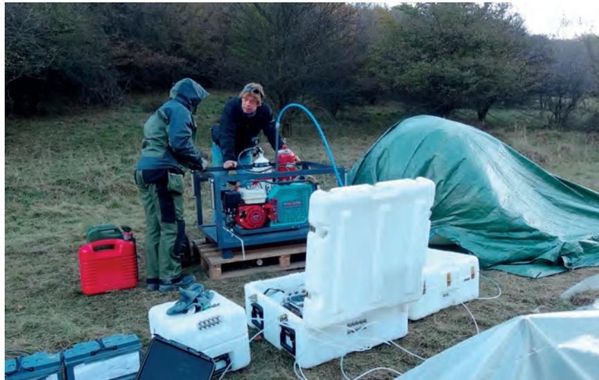
Prueba de un muestreador automático formulado a efectos de la realización de inspecciones *in situ* (contribución en especie de los Estados Unidos), durante un ensayo sobre el terreno de muestreo de gases nobles del subsuelo realizado en Eslovaquia en octubre de 2012.
