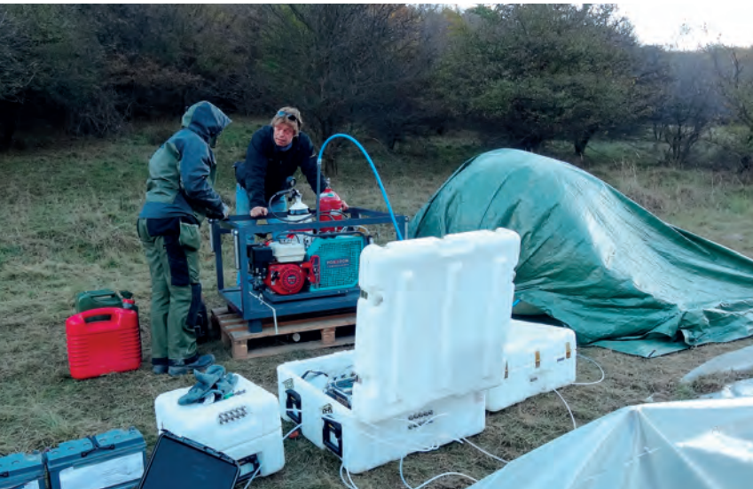
اختبار جهاز ذكي لأخذ العينات استُحدث لأغراض التفتيش الموقعي (مقدم كمساهمة عينية من الولايات المتحدة الأمريكية). أثناء اختبار ميداني لتقنيات أخذ عينات الغازات الخاملة من التربة السفلية، سلوفاكيا، تشرين الأول/أكتوبر ٢٠١٢.
