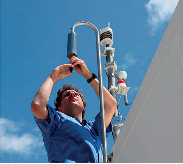
محطة رصد النويدات المشعة RN44، غيريرو نيفرو، باخا كاليفورنيا، المكسيك: إجراء اختبار أداء بالسبّر لنظام رصد الغازات الخاملة، الذي اعتُمد في عام ٢٠١٢.
