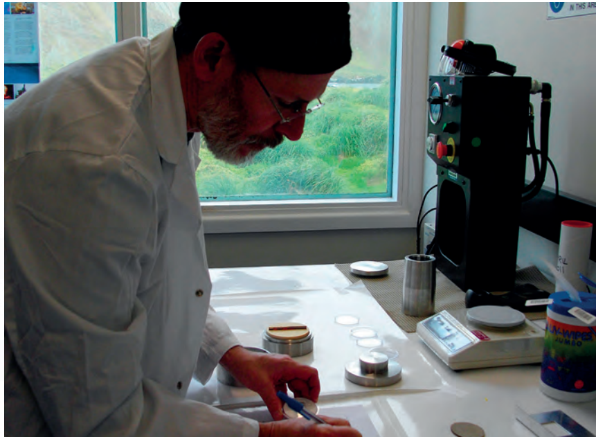
محطة رصد النويدات المشعّة RN7، جزيرة ماكاراي، أستراليا، التي اعتُمدت في عام ٢٠١٢. الصورة اليمنى: تحضير المرشّح بعد نزعها من جهاز أخذ العينات من الهواء (الصورة اليسرى).
