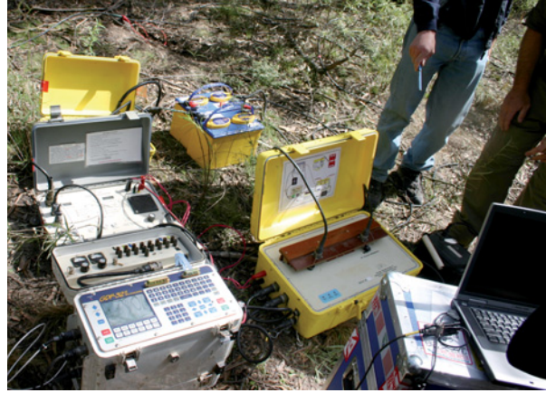
Démonstration de matériel d'inspection sur place en Australie: matériel de mesure de la résistivité.
