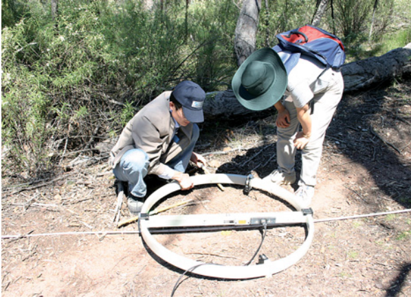
Démonstration de matériel d'inspection sur place en Australie: mise à niveau d'une bobine réceptrice utilisée pour mesurer les champs magnétiques induits.
