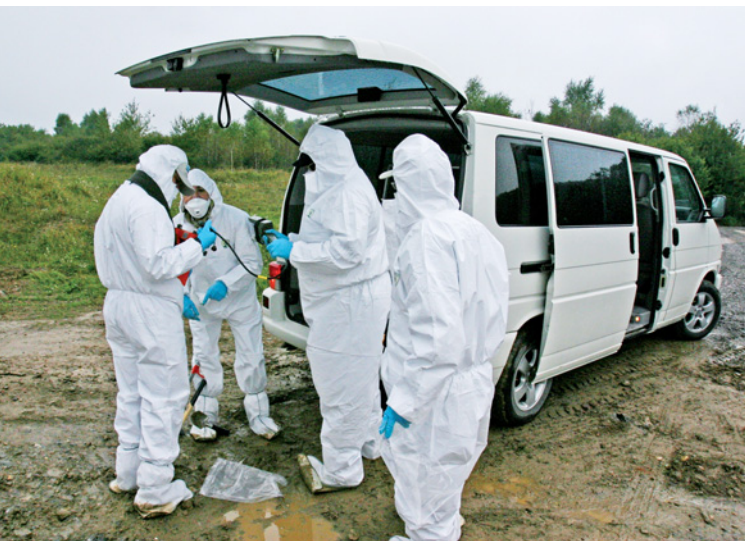
Deuxième partie du stage de formation initiale aux inspections sur place (Slovaquie): les participants apprennent comment prélever des échantillons de radionucléides.
