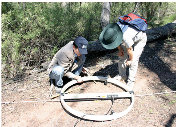
现场视察设备演示，澳大利亚：正在校准用于测量感应磁场的接收机线圈。
