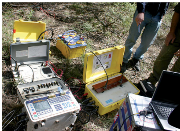
现场视察设备演示，澳大利亚：电阻率测量设备。
