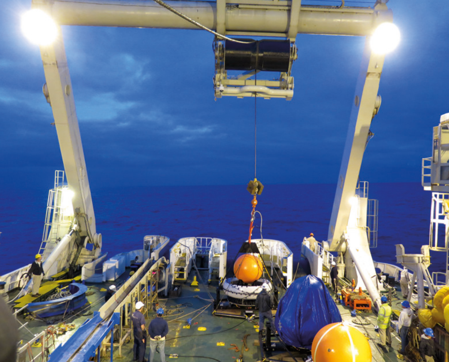
Восстановление гидроакустической станции НАЗ, острова Хуан-Фернандес, Чили
