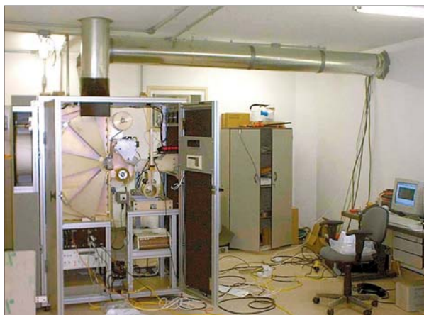
Echantillonneur manuel de particules installé à la station de surveillance des radionucléides RN11 (Rio de Janeiro, Brésil)
