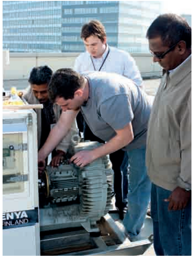
Participants à un stage de formation technique tenu à Vienne en 2010 à l'intention des opérateurs de station. A gauche : Etalonnage d'un baromètre à infrasons. A droite : Remplacement de l'échantillonneur d'air dans un dispositif de surveillance des radionucléides.
