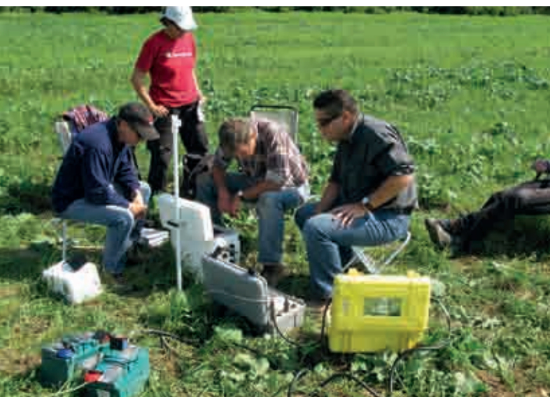
Utilisation de matériel de sondage électromagnétique pendant un essai sur le terrain réalisé à Pecs (Hongrie), en septembre 2010. Ce genre de matériel peut être utilisé pendant la période de poursuite d'une inspection sur place pour détecter des anomalies causées par des structures artificielles et les équivalents géologiques de signaux caractéristiques d'une explosion nucléaire souterraine.
