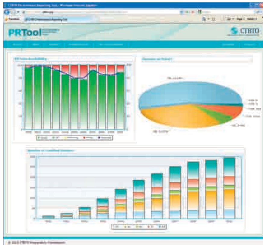
Saisie d'écran montrant les indicateurs du système de vérification affichés par l'outil PRTool. En haut à gauche : Evolution de la disponibilité des données des stations de surveillance des radionucléides du SSI entre 2000 et 2010. En haut à droite : Ventilation par type de rapports, demandes et notifications provenant des installations du SSI reçus en 2010 par le CID. En bas : Progression du nombre de stations certifiées du SSI, par technique de surveillance, entre 2000 et 2010.
