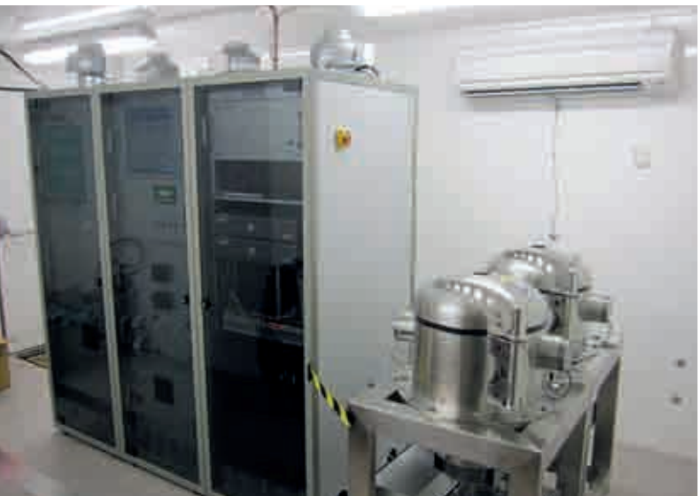
Système SAUNA de détection des gaz rares à la station de surveillance des radionucléides RN68, située à Tristan da Cunha (Royaume-Uni).
