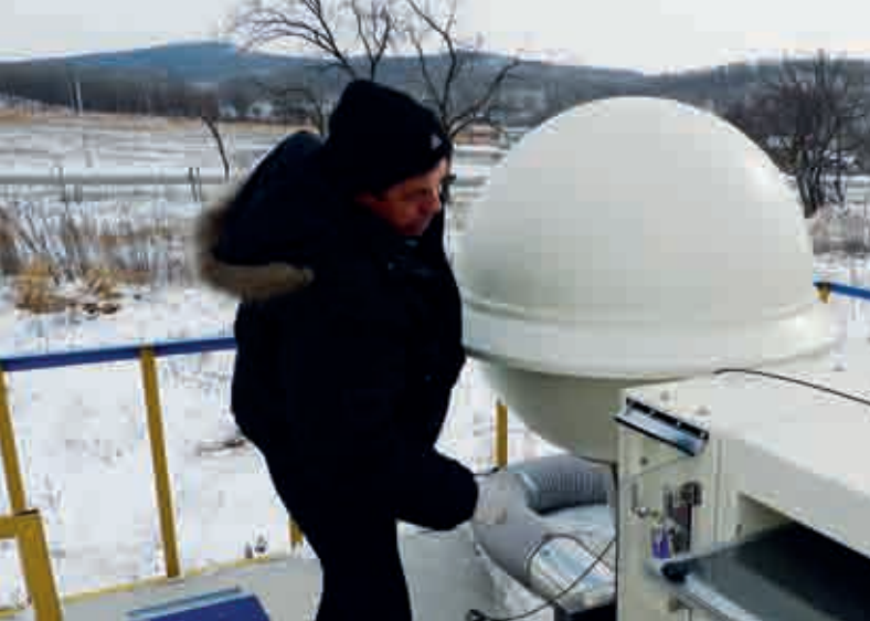
A la station de surveillance des radionucléides RN58 située à Oussourisk (Fédération de Russie), certifiée en juin 2010: remplacement du filtre de l'échantillonneur d'air.
