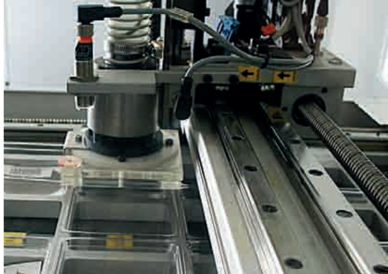
Bras robotisé servant à manipuler les filtres à la station RN53.
