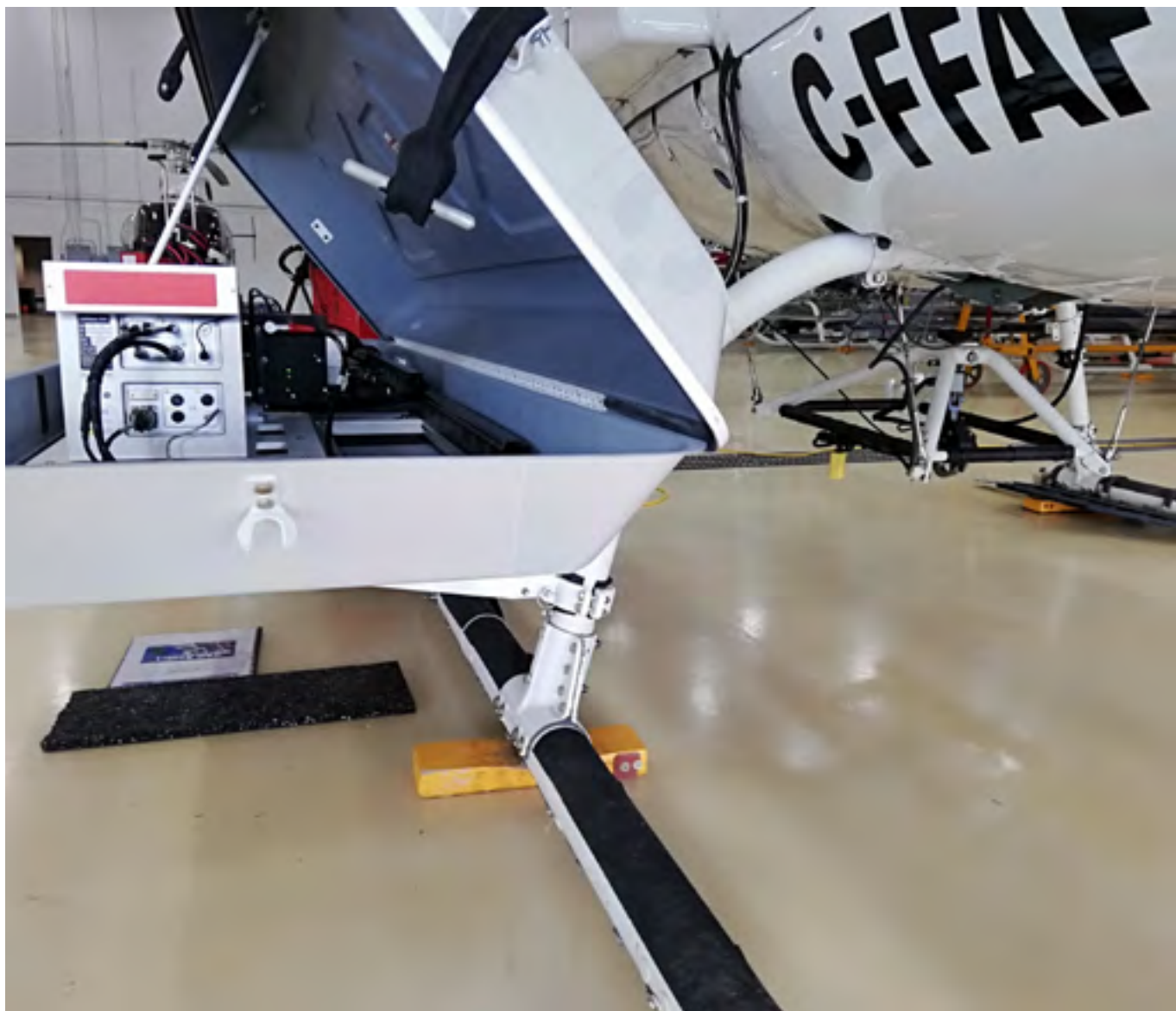
Configuración del equipo de obtención de imágenes MSIR en un helicóptero AS350 durante el curso avanzado sobre técnicas aerotransportadas del tercer ciclo de formación sobre IIS impartido en 2019 en el Canadá.
