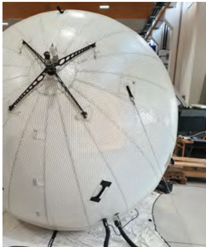
Terminal desplegable de comunicaciones por satélite del sistema de antena GATR en el Centro TeST.
