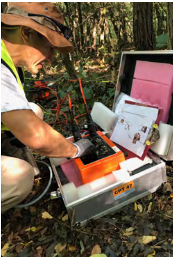
Mediciones de la conductividad eléctrica durante el ensayo sobre el terreno de técnicas geofísicas para IIS realizado en 2019 en Hungría.
