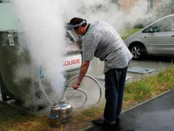
Arriba: Llenado de un recipiente Dewar con argón líquido para la refrigeración del sistema ARIX-3F.
