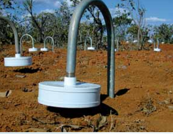
صورة تفصيلية لنظام تخفيض ضوضاء الرياح في المحطة دون السمعية في أستراليا IS7, Warramunga, Northern Territory, Australia
