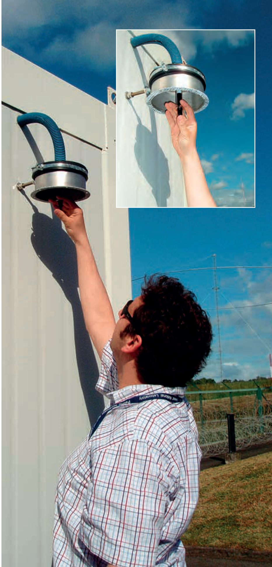
В рамках сертификации радионуклидной станции RN29 на о-ве Реюньон (Франция) сотрудник ВТС проверяет исправность работы системы мониторинга путем введения радиоактивного ксенона.
