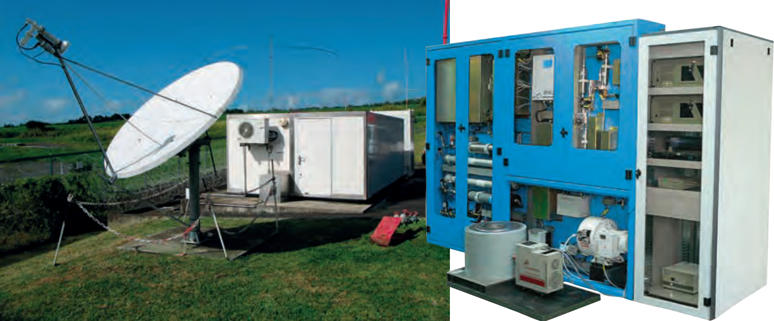
Радионуклидная станция RN29 на о-ве Реюньон (Франция) в Индийском океане к востоку от Мадагаскара. Станция RN29 оснащена системой мониторинга благородных газов типа SPALAX (справа). Это первая система данного типа, прошедшая сертификацию в качестве объекта МСМ.
